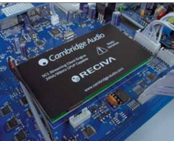
Das ist der Kern: In diesem Modul werden die Netzwerkdaten empfangen und in weiterverarbeitbare Form gebracht
